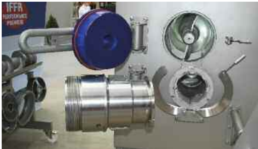
Новый волчок CFS PowerGrind для замороженного и свежего мяса получил расширенную загрузочную зону и уникальное устройство откидывания горловины, которое облегчает и делает более безопасными процессы обслуживания и мойки машины
