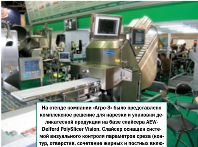
На стенде компании «Агро-З» было представлено комплексное решение для нарезки и упаковки деликатесной продукции на базе слайсера AEW-Delford PolySlicer Vision. Слайсер оснащен системой визуального контроля параметров среза (контур, отверстия, сочетание жирных и постных включений) для коррекции резов. Это позволяет минимизировать вынужденный привес упаковок при переработке таких сложных продуктов, как сыры и деликатесы
