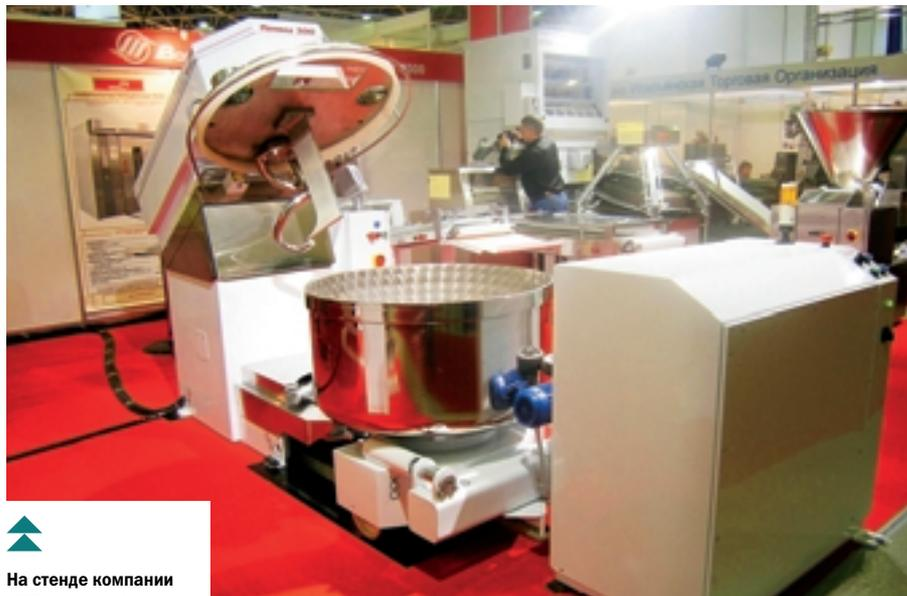
На стенде компании НПП «Восход» был представлен целый ряд новинок оборудования: в частности, тестоприготовительный комплекс «Прима-300 AP» на базе тестомесильной машины «Прима-300» с загрузчиком опары, предназначенный для окончательного замеса теста при опарных технологиях
