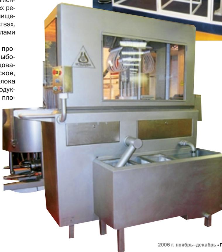
На стенде компании «ПТИ» была продемонстрирована линейка оборудования известной испанской компании Metalquimia, составляющая линию по производству ветчинных батонов. На снимке: иньектор высокого давления MV 30РС. Несмотря на то, что подобное оборудование демонстрируется на выставке впервые, на ряде российских предприятиях иньекторы Metalquimia давно и успешно эксплуатируются
