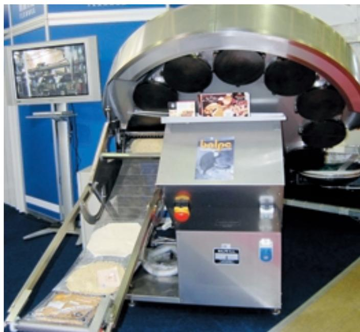
На стенде компании ППК была представлена машина фирмы Valre (Франция) для автоматического приготовления тонких круглых продуктов (блинов, омлетов и пр.) с наклонным столом и 12 электроннагреваемыми дисками
