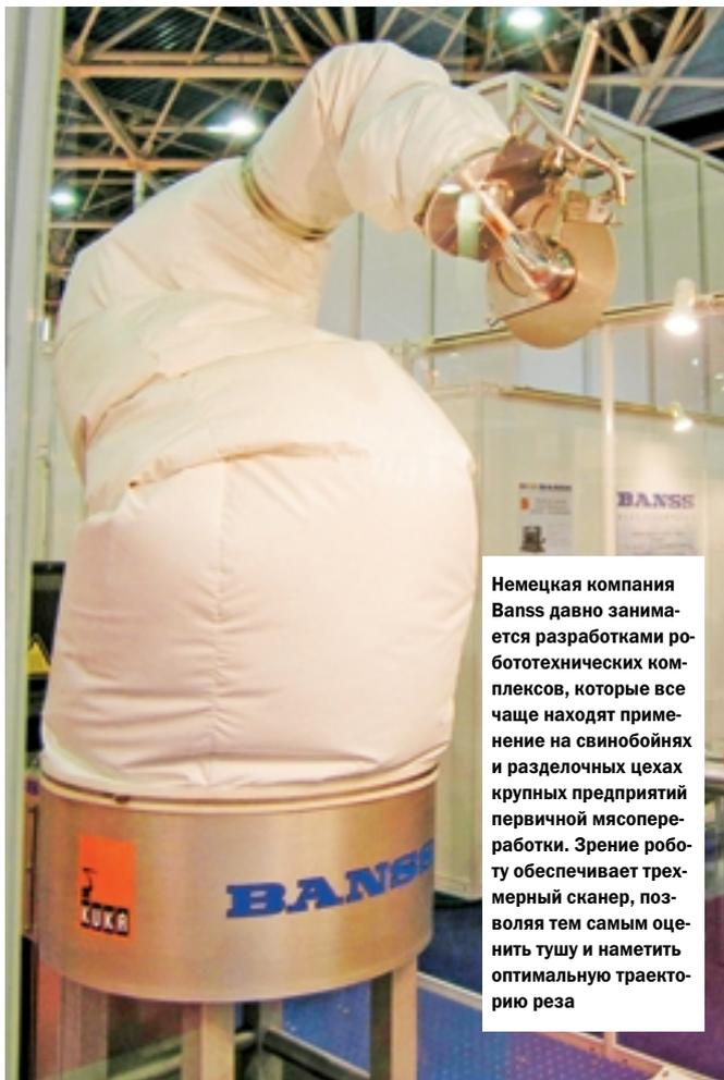
Немецкая компания Banss давно занимается разработками робототехнических комплексов, которые все чаще находят применение на свинойбойнях и разделочных цехах крупных предприятий первичной мясопереработки. Зрение роботу обеспечивает трехмерный сканер, позволяющий тем самым оценить тушу и наметить оптимальную траекторию реза
