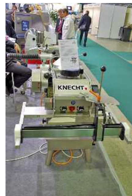
На стенде компании «Антеc» был представлен новейший универсальный станок Knecht S20 для заточки обвалочных/разделочных ножей, ножей для куттеров объемом до 750 л, дисковых ножей. Инновационная система ведения ножа позволяет провести заточку, полировку и удаление заусенцев за один установ
