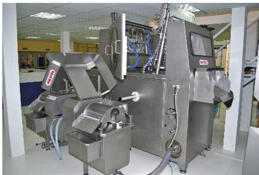
◀ Среди множества перспективных машин, представленных в этом году на стенде Schaller Lebensmitteltechnik, особое место занимала линия Inject Star для инъектирования куриных тушек, состоящая из диагонального инжектора с двумя иглоносителями BI 424-C P для непрерывного шприцевания мяса птицы на кости или без костей и проходного массажера типа PA-3500 для удаления лишнего рассола из пустот в шприцованных куриных тушках. На фото: диагональный инжектор Inject Star BI 424-C P
