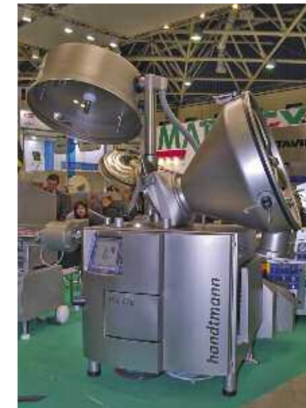
Периметр стенда компании Matimex по традиции «огорожен» новейшими моделями машин, которые она представляет на российском рынке. Среди наиболее интересных — новейшая высоковакуумная система для набивки ветчинных продуктов Handtmann HVF 670
